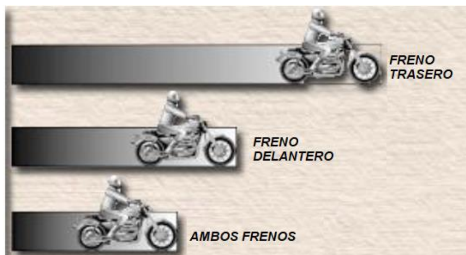
FIGURA NRO. 6. Distancia de frenado según el freno empleado. MIRANDA, José (2019)
