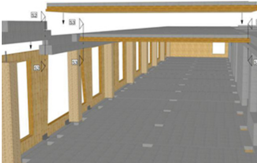
Fig. 2: Montaje de los elementos de borde
